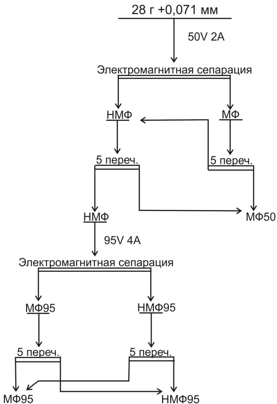
Рис. 55 Схема проведения электромагнитного опыта для хвостов гравитации с месторождения Средняя Падма
