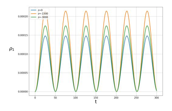
3.2.3) Зависимость динамической добавки плотности  $\rho_1$  от времени t при Z=0,-1500,-3000м. Длина волны  $\lambda=2000$ м.
