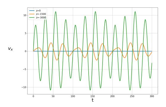
6.1.2.) Зависимость составляющей скорости  $v_x$  от времени t при Z=0,-1500,-3000м. Длина волны  $\lambda=200$ м.
