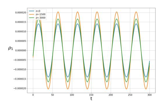
3.2.2) Зависимость динамической добавки плотности  $\rho_1$  от времени t при Z=0,-1500,-3000м. Длина волны  $\lambda=200$ м.
