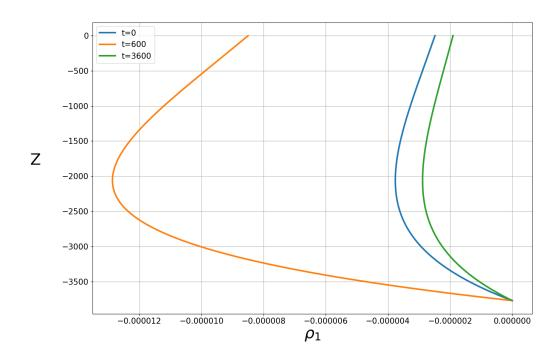
3.1.2) Зависимость динамической добавки плотности  $\rho_1$  от глубины Z при t=0,600,3600с. Длина волны  $\lambda=200$ м.
