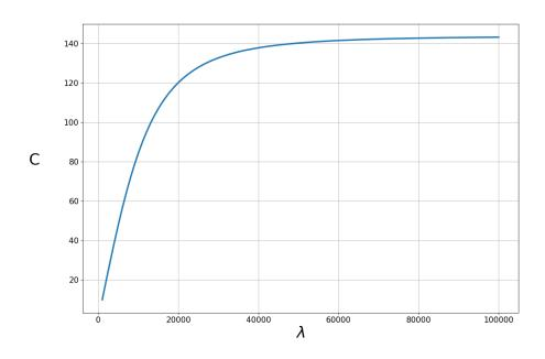
Здесь мы можем отметить, что циклическая частота ведет себя неравномерно на всем промежутке, показывая более высокий градиент скорости для длин волн до 5км. При длине
