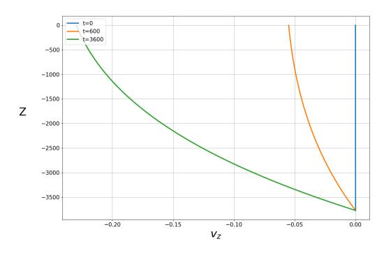
2.1.3) Зависимость вертикальной составляющей скорости  $v_z$  от глубины Z при t=0,600,3600с. Длина волны  $\lambda=2000$ м.
