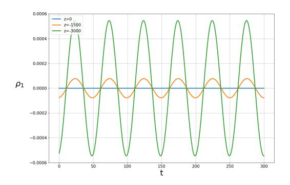
6.1.2.) Зависимость динамической добавки плотности  $\rho_1$  от времени t при Z=0,-1500,-3000м. Длина волны  $\lambda=200$ м.
