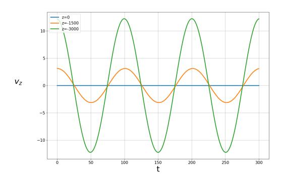
6.1.2.) Зависимость составляющей скорости  $v_z$  от времени t при Z=0,-1500,-3000м. Длина волны  $\lambda=200$ м.
