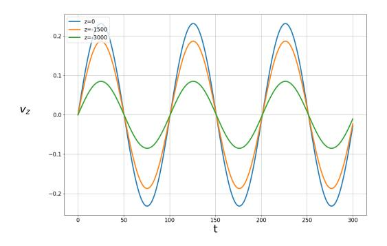
2.2.3) Зависимость вертикальной составляющей скорости  $v_z$  от времени t при Z=0,-1500,-3000м. Длина волны  $\lambda=2000$ м.
