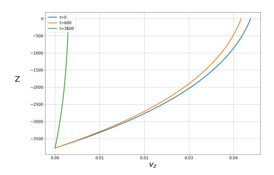
2.1.2) Зависимость вертикальной составляющей скорости  $v_z$  от глубины Z при t=0,600,3600с. Длина волны  $\lambda=200$ м.
