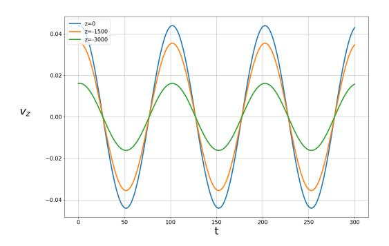
2.2.2) Зависимость вертикальной составляющей скорости  $v_z$  от времени t при Z=0,-1500,-3000м. Длина волны  $\lambda=200$ м.
