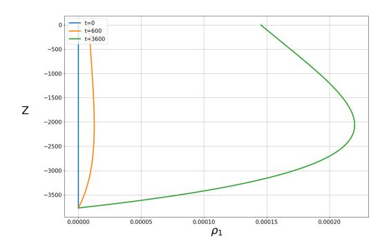
3.1.3) Зависимость динамической добавки плотности  $\rho_1$  от глубины Z при t=0,600,3600с. Длина волны  $\lambda=2000$ м.
