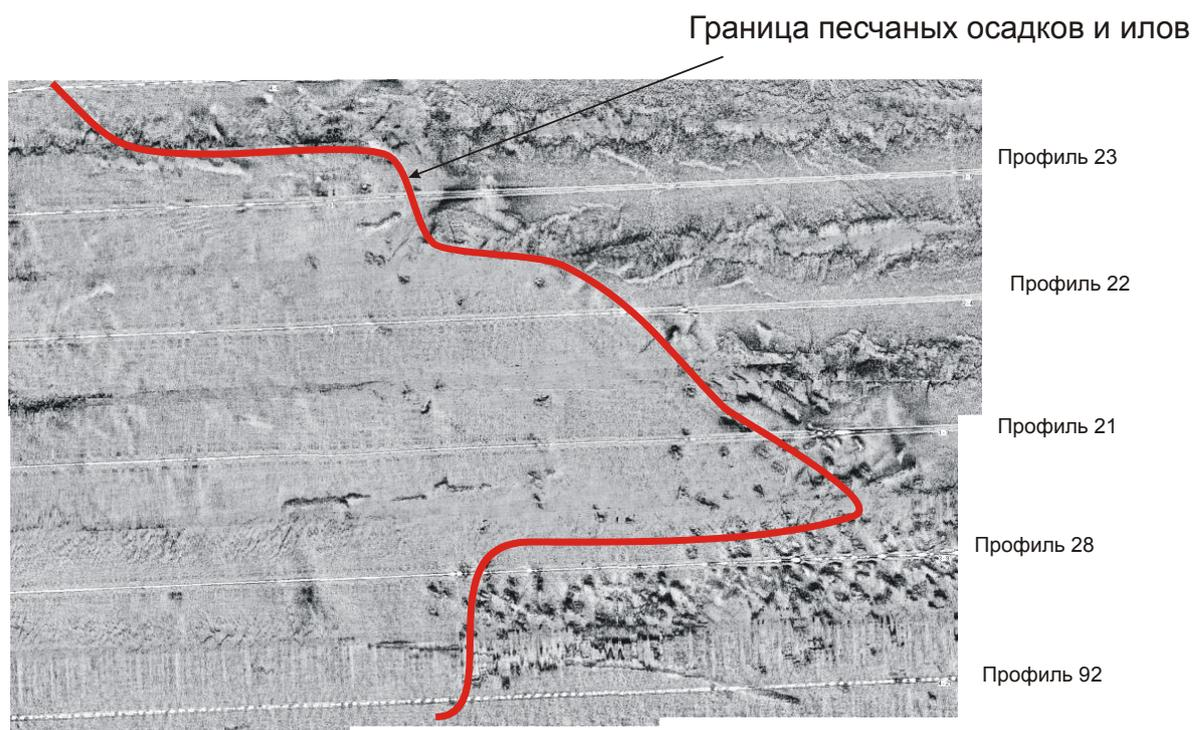
Рис.17. Фрагмент схемы-мозаики профилирования ГЛБО с изображением границы грубообломочных отложений и песков и свалки грунта.
