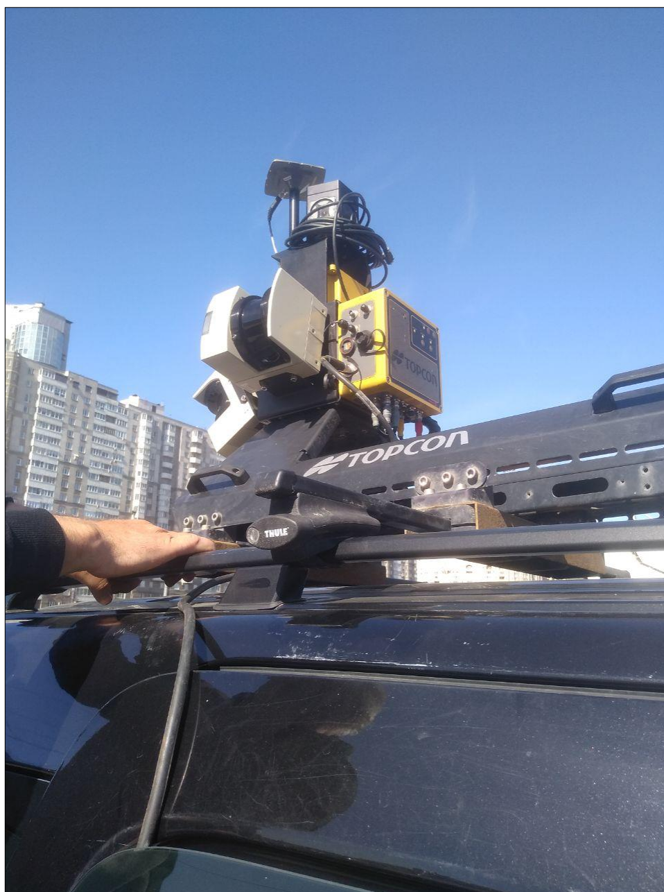
Рис. 5 – Сканирующая система Topcon IP-S2 на мобильной платформе Renault Kangoo
