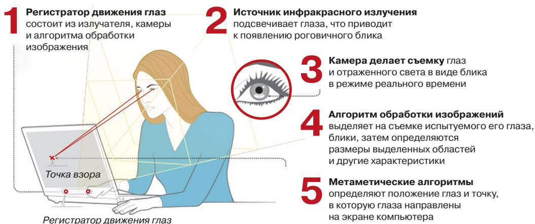
Рис. 1.6. Принцип работы регистратора движения глаз
