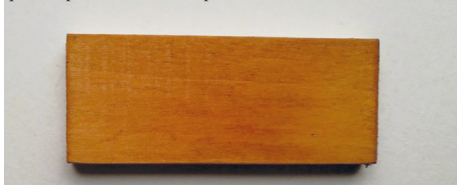
Рис. 5. Образец № 5. Обработка поверхности белой березы раствором катеху и раствором медного купороса. Образец выполнен на кафедре реставрации СПбГУ авторами статьи
