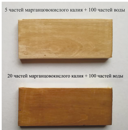
Рис. 1. Образец № 1. Обработка поверхности белой березы растворами марганцовокислого калия. Образец выполнен на кафедре реставрации СПбГУ авторами статьи
