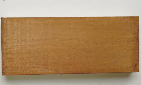
Рис. 8. Образец № 8. Обработка поверхности белой березы раствором железных опилок в уксусной кислоте. Образец выполнен на кафедре реставрации СПбГУ авторами статьи
