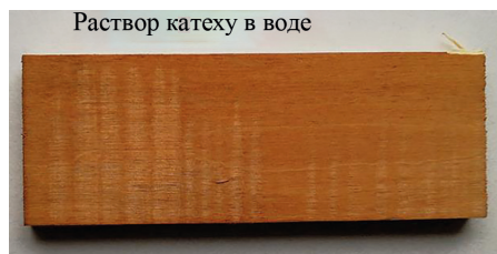
Рис. 3. Образец № 3. Обработка поверхности белой березы раствором катеху. Образец выполнен на кафедре реставрации СПбГУ авторами статьи
