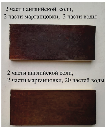
Рис. 2. Образец № 2. Обработка поверхности белой березы растворами марганцовокислого калия с добавлением английской соли. Образец выполнен на кафедре реставрации СПбГУ авторами статьи
