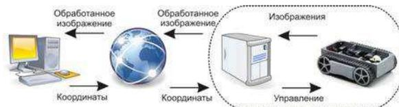
**Рис. 4.** Предлагаемый подход — контур управления замкнут на локальном сервере
