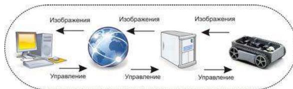
**Рис. 3.** Классический подход — контур управления замкнут на удаленном компьютере
