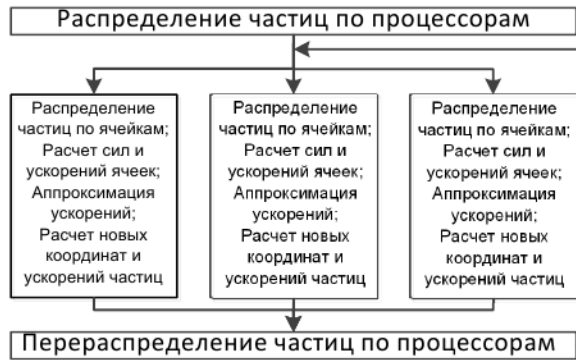
Рис. 1. Схема распараллеленной программной реализации модели
