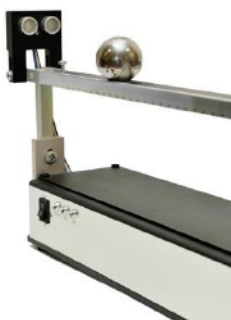
Рис. 1. Управляемое устройство. Ультразвуковой датчик
