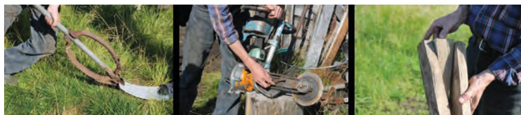
Рис. 5. Самодельные инструменты для обработки металла: «загибалка», модернизированная пила «Дружба», деревянные тиски. Фото А. В. Раевой, август 2018 г.
