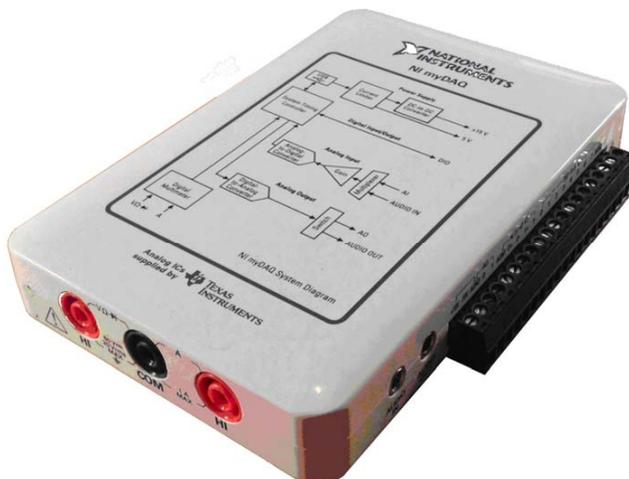
Рис.3.5. Устройство сбора данных NI myDAQ.
