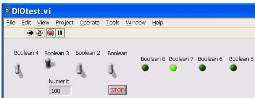
Рис.3.32 . Тестирование программы с виртуальными светодиодами.
