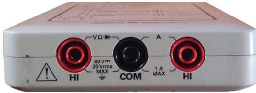
Рис.3.6. Входы цифрового мультиметра на лицевой стороне NI myDAQ.
