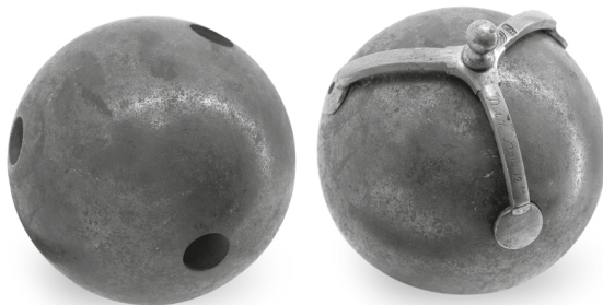
Рис. 9. Брандскугель Нижнеисетского завода и тот же брандскугель с инструментом Каменского завода для определения мест размещения пробок у брандскугелей 12-фунтового калибра. Из коллекции Горного музея
