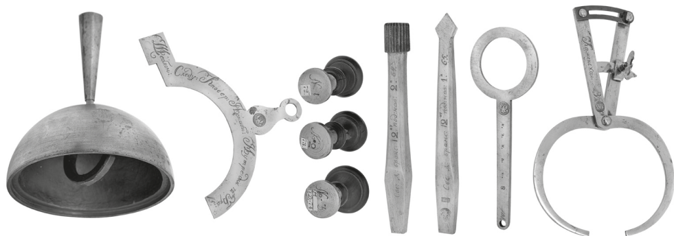
Рис. 7. Инструменты для отливки и отделки артиллерийских снарядов Каменского литейного завода. 1828 г. Из коллекции Горного музея
