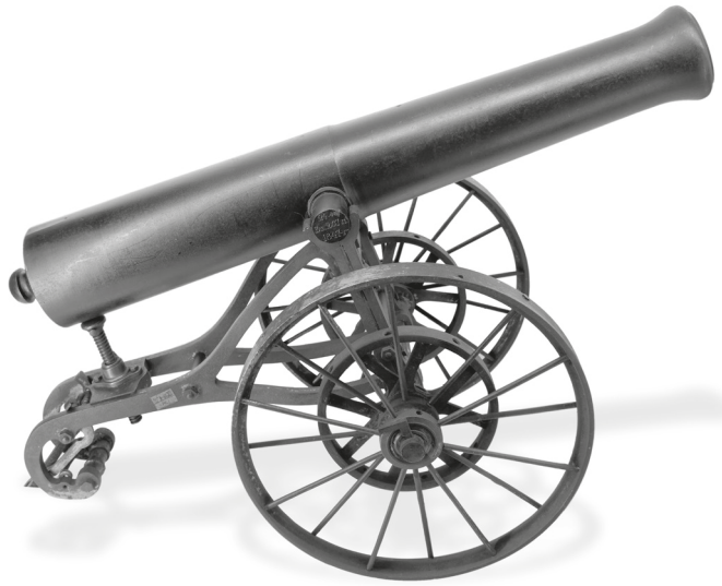
Рис. 3. Модель 24-фунтового орудия крепостной артиллерии на лафете Венгловского. Александровский пушечный завод. Петрозаводск. 1847 г. Масштаб 1:8. Из коллекции Горного музея
