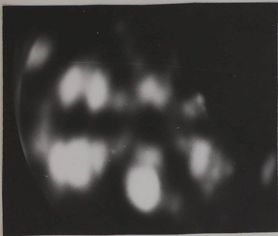
Рис.3.10. Эмиссионное изображение соответствующее субмонослойному покрытию Au на поверхности Ge эмиттера после прогрева до температуры 400 К.
