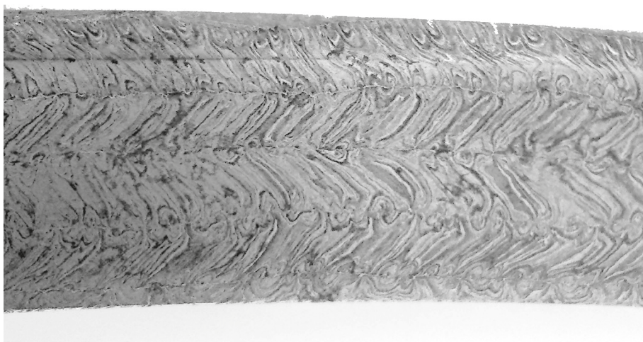
Рис. 8. Фрагмент клинка сабли из дамаска из «Технического кабинета» 475 (366) × 20 мм. Из коллекции Горного музея
