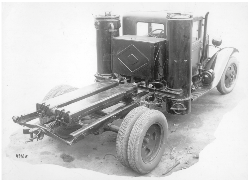
Шасси ГАЗ-42 — газогенераторной модификации ГАЗ-АА. (Матвеевко В. И. Знаменитые и... забытые. СПб., 2012. С. 63)
