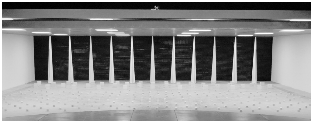
Рис. 4. Расположение вихрегенераторов и призм в рабочей части аэродинамической трубы при проведении эксперимента.
