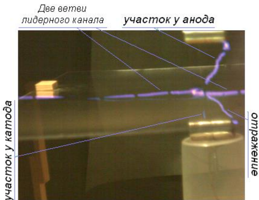
Рис. 2.493. Разветвление лидерного канала при огибании барьера. Пробой в результате воздействия биполярной импульсной короны. Симметричная система электродов. Напряжение 160 кВ. Разрывы в изображении лидерного канала – след металлической сетки, защищающей камеру; на самом деле он непрерывен.
