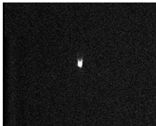
Рис. 2.554. Общий вид положительной короны ( h = 2 мм).
