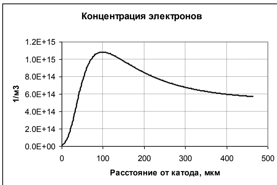
Рис. 2.316. Концентрация электронов. Напряжение 5,5 кВ.
