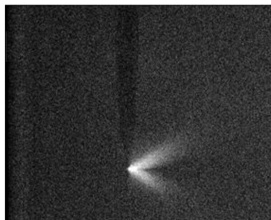
Рис. 2.542. Общий вид отрицательной короны ( h = 0 мм)
