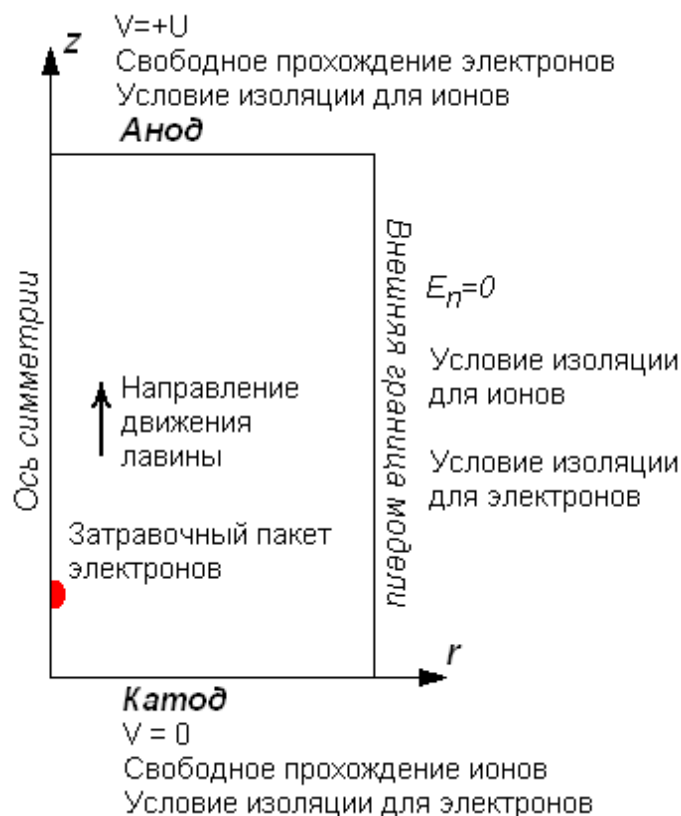
Рис. 2.146. Схема модели и граничные условия.
