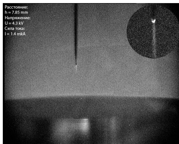
Рис. 2.517. (а) - отрицательная корона, напряжение -6.3 кВ; (б) - положительная корона, напряжение +4.3 кВ; h – расстояние от иглы до плоскости.
