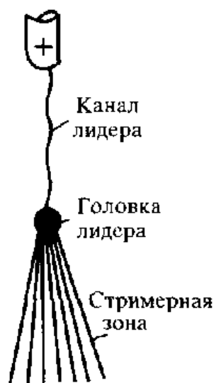
Рис. 2.80. Схема структурных элементов лидера.
