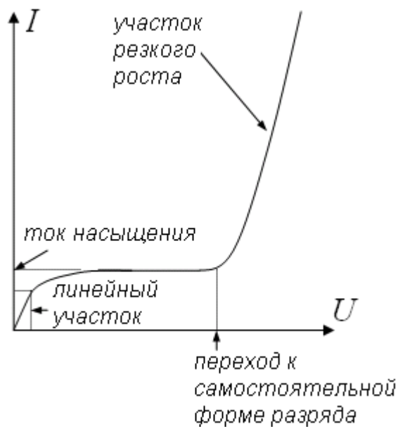
Рис. 1.1. Типовая вольтамперная характеристика газа.
