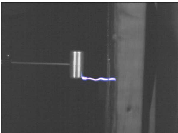
Рис. 2.462. Пробой в системе электродов цилиндр-плоскость при межэлектродном расстоянии 50 мм. Напряжение +80 кВ.
