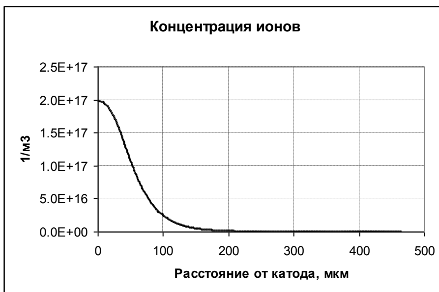
Рис. 2.317. Концентрация ионов. Напряжение 5,5 кВ.
