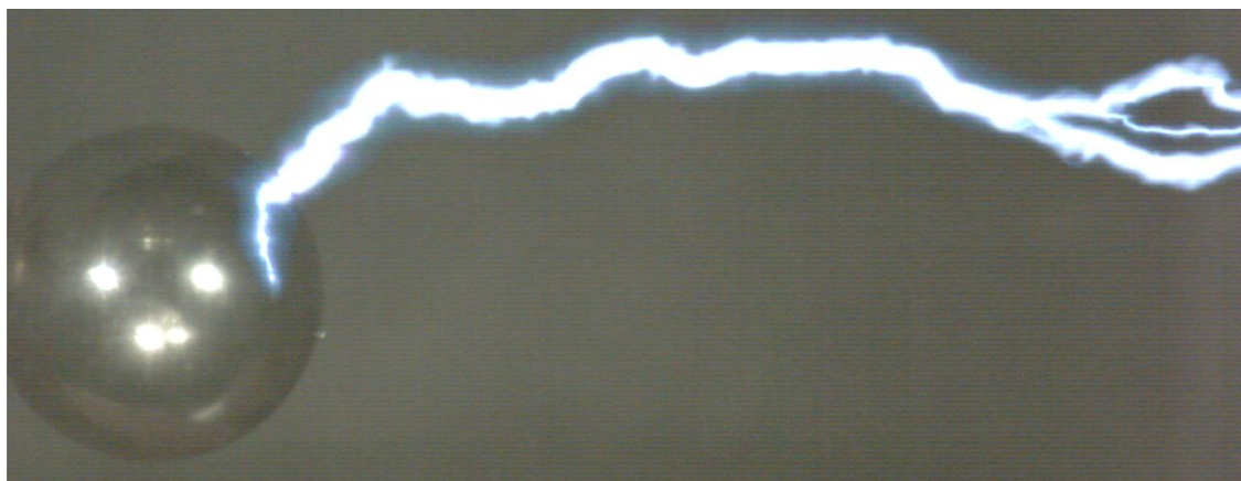
Рис. 2.129. Фотография сквозной фазы лидерного процесса от положительного сферического электрода. На начальном участке у шарового электрода толщина лидерного канала относительно тонкая, ток в канале судя по осциллограмме пробоя равен 400 А.
