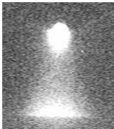
Рис.2.264. Фоторафия диффузного свечения всего межэлектродного промежутка, напряжение 23кВ.
