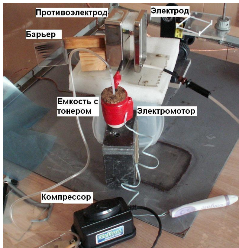
Рис. 2.538. Установка для определения зависимости интенсивности почернения от плотности заряда
