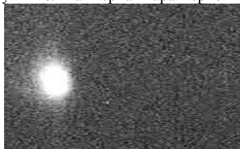
2.285. Локализованная форма КР при 0.01атм, напряжение 1.5кВ.
