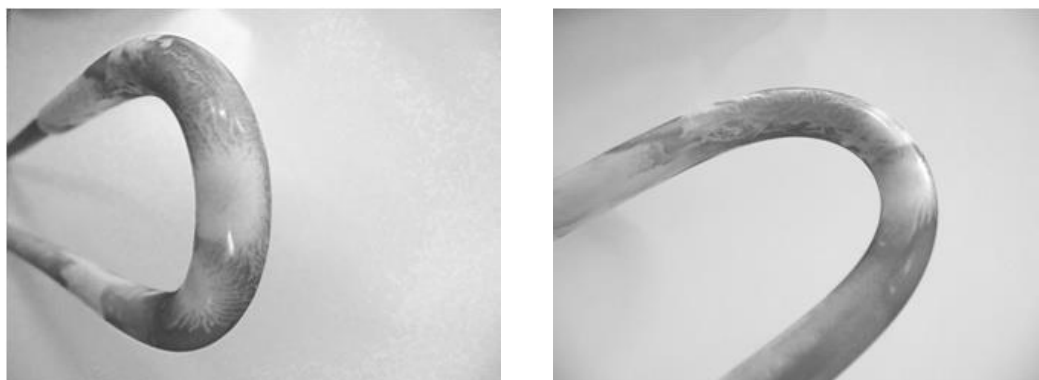
Рис. 2.373. Визуализация заряда на поверхности диэлектрика после серии экспериментов по наблюдению стримеров тонером лазерного принтера. Межэлектродное расстояние 70 мм. Напряжение 100 кВ. Количество поданных импульсов: 10.
