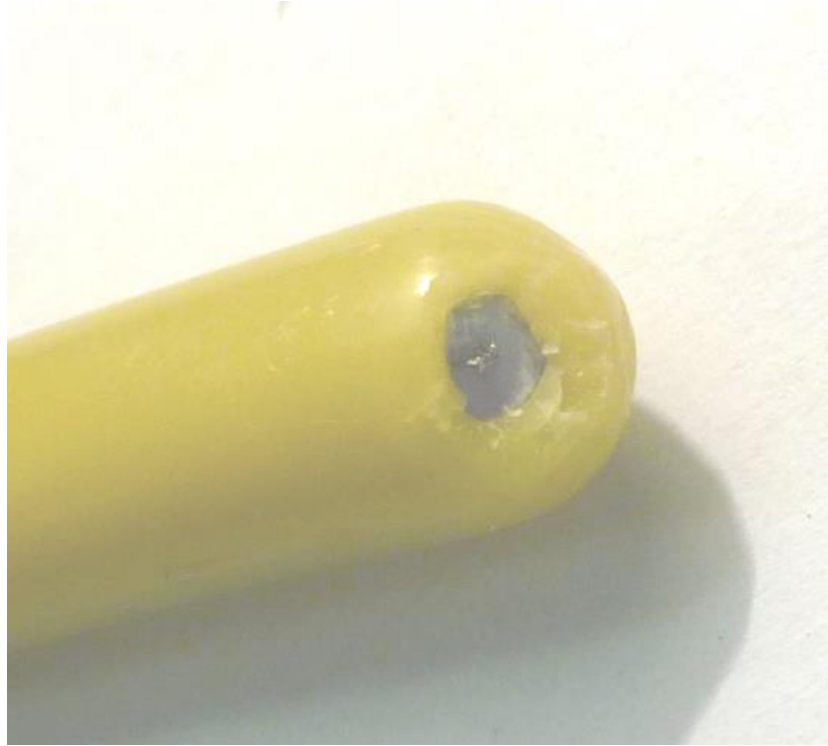
Рис. 2.405. Типичный скол на краях каверны - отверстия в изоляции, образованном искровым разрядом. Толщина однослойной изоляции из воска 2.33 мм. Напряжение пробоя +190 кВ
