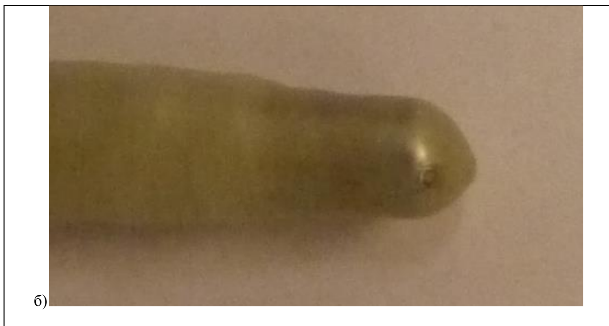
Рис. 2.402. Пробой изоляции из ЭВА: а) вид пробоя с места меньшей толщины изоляции (0.5 мм) при толщине ЭВА у закругления 1 мм при напряжении + 180 кВ; б) вид пробоя с закругления при увеличении зоны покрытия парафином. Толщина ЭВА 0.68 мм, напряжение пробоя +160 кВ.
