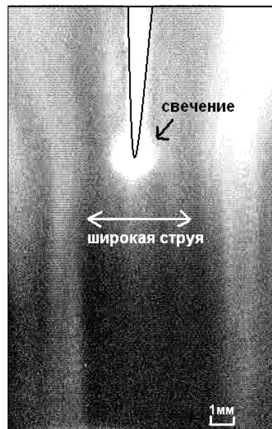
Рис. 2.579. ЭВ при высоких напряжениях отрицательной полярности (-11 кВ).
