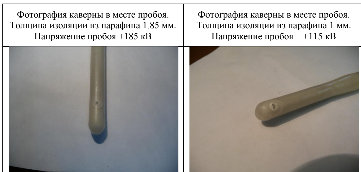
Рис. 2.396 Изображение последствий пробоя изоляции из парафина. Слева толщина изоляции 1.85 мм, справа 1 мм.
