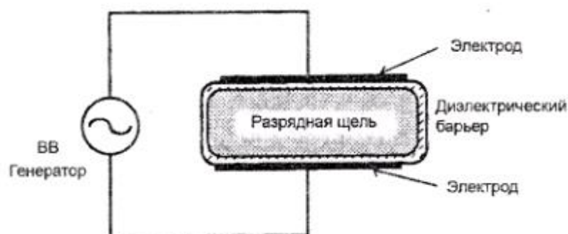
Рис. 2.509. Конфигурация барьерного разряда с двумя диэлектрическими слоями.
