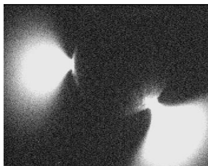
Рис. 2.590. Очаги отрицательного коронного разряда на электроде-сфере.
