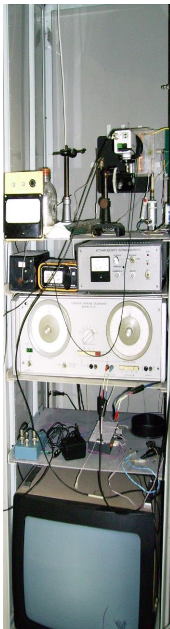
Рис. 2.568. Установка для изучения электрического ветра в воздухе.
