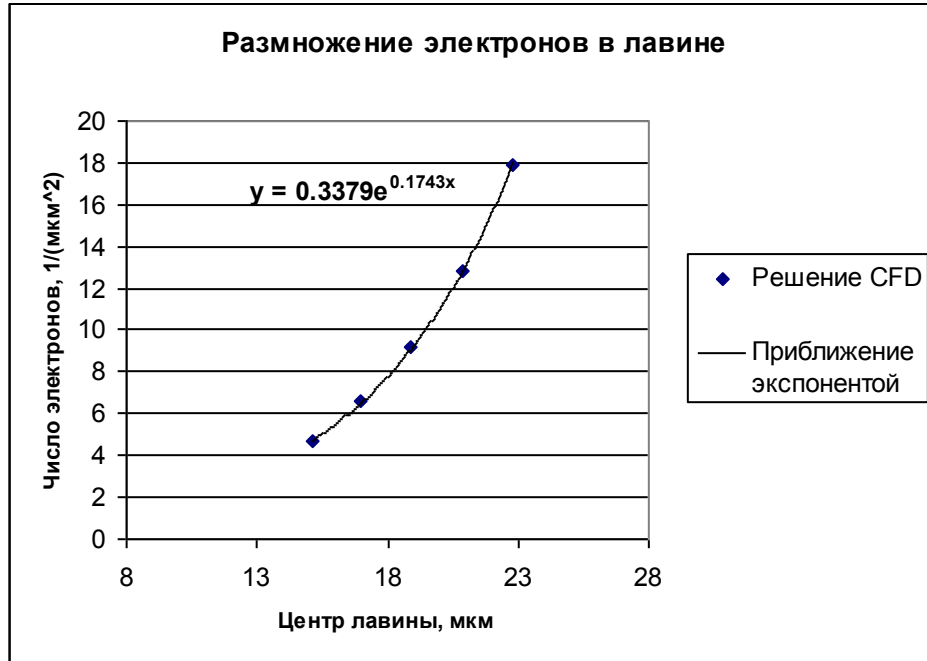
Рис. 2.42. Подсчет полного числа электронов в определенный момент времени позволяет определить коэффициент столкновительной ионизации. E = 80 кВ/см.
