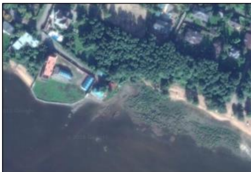
Рисунок 29. Размыв пляжа к востоку от ул. Морские Дубки, 4 из-за возведения мысообразной буны.
