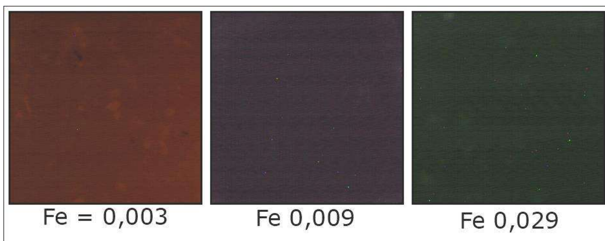
Рисунок 15. Вариация цветов слабо возбуждённой железо-содержащей шпинели разных образцов и их соответствующие коэффициенты железа в формуле, рассчитанные на основе данных по микрондовому анализу
