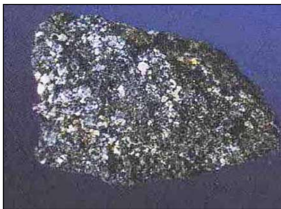
Образец 3. Порода, слагающая дайку, с минеральной ассоциацией: слюда, графит, кальцит. Размер 29 мм
