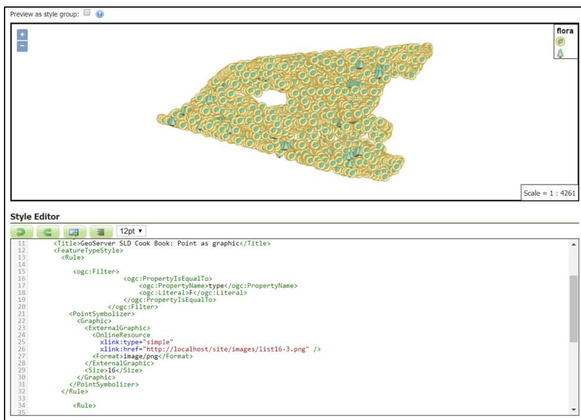
Рисунок 10. Настройка стиля визуализации для точечного слоя в GeoServer.
