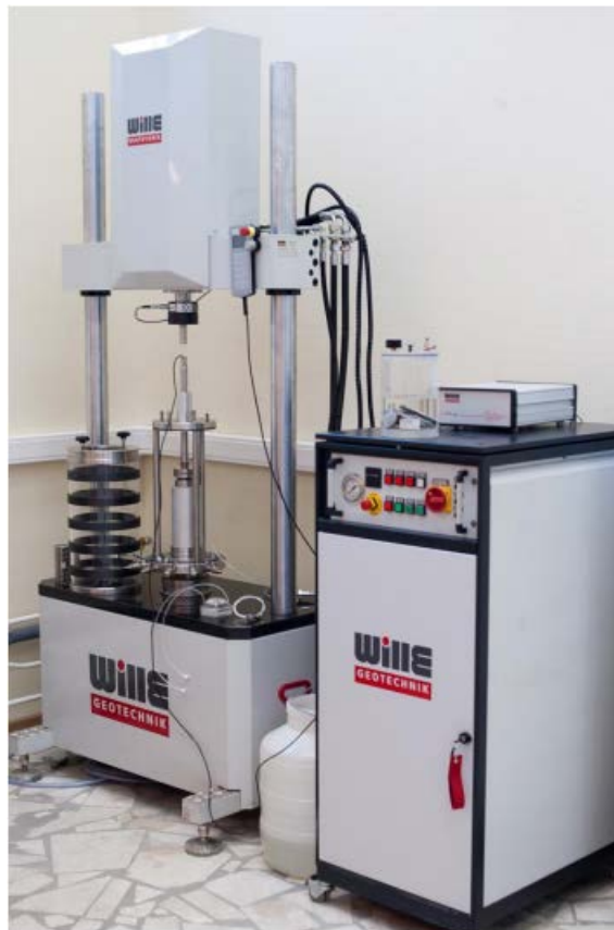
Рис.3. Общий вид установки трехосного сжатия с возможностью вибрационного нагружения
