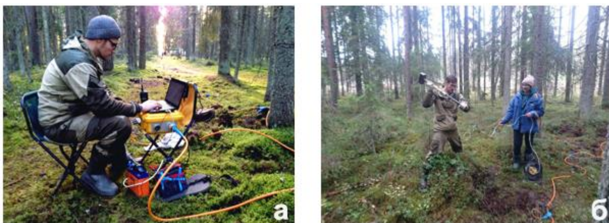
Рисунок 15 - Регистрация колебаний с помощью линейной сейсморазведочной станции «ЭЛЛИСС-3» (а) и возбуждение колебаний кувалдой (б).
