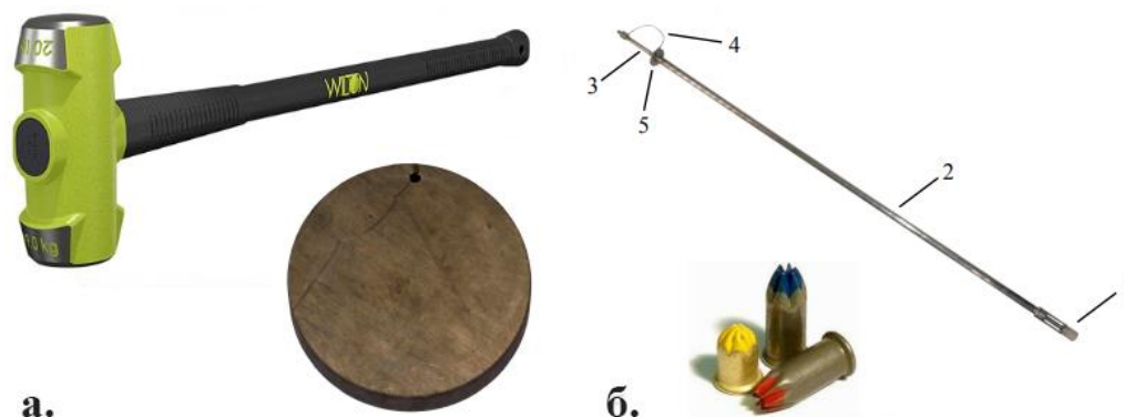
Рисунок 16 - Источники сейсмических колебаний: строительная кувалда и плашка (а), пороховой сейсморазведочный источник типа «Пика-Д» (б).
