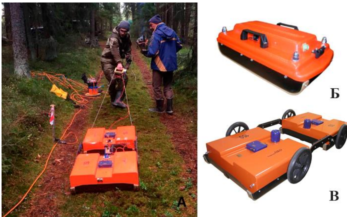
Рисунок 20 - Проведение тестовых работ методом георадиолокации (А), георадары «ОКО-2» с антеннами: 150 (Б) и 400 МГц (В).
