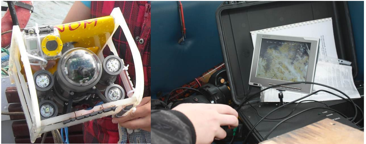
Рисунок 11. Аппаратура для подводной видеосъемки. А – ПТУ «Супер-ГНОМ» с камерой GoPro; Б – система управления и экран, выводящий изображение на борт судна
