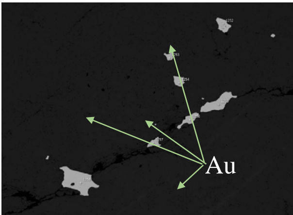
Рис. 19 Агрегат золота (вид в аншлифе под микроскопом) из жилы Полосчатая
