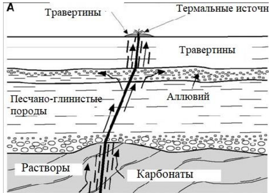
Рисунок 3. Разрез профиля формирования «Термогенных травертинов» (Pentecost 2005).
