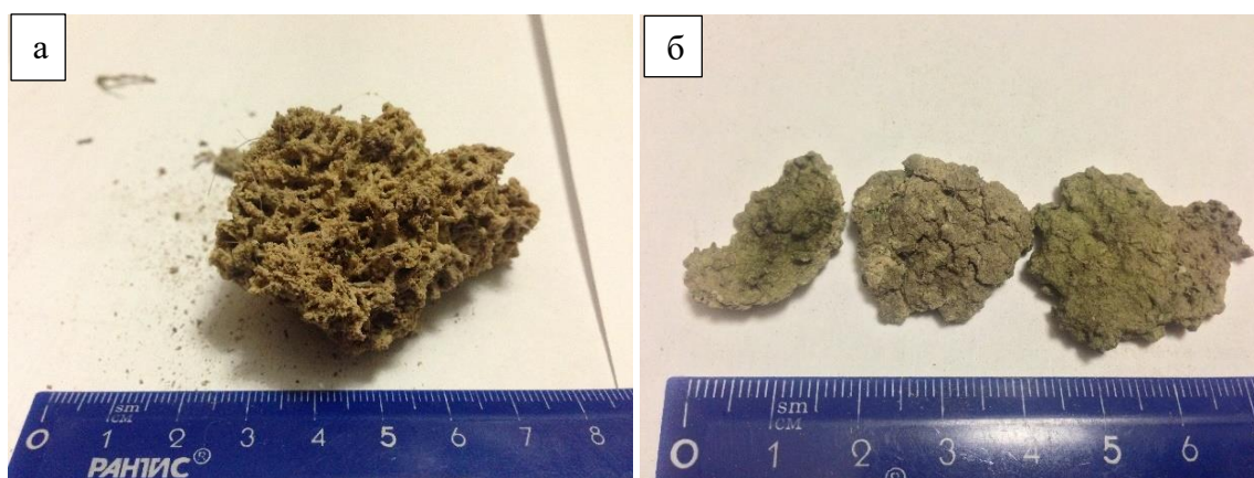
Рисунок 12. Фото образцов: а – травертин, б – гажа.
