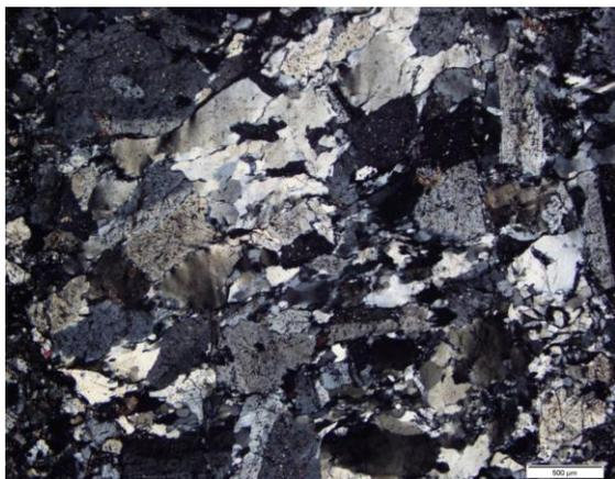
Рис. 16. Образец 15-v15-28/16. Катаклазированный плаггиогранит с анализатором
