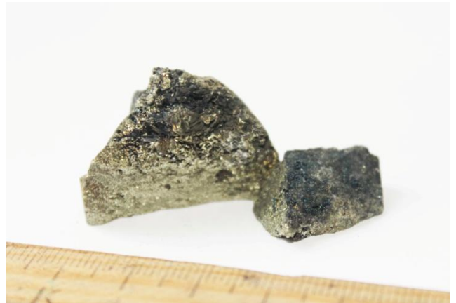
Рисунок 10: внешний вид массивных сульфидов внешней зоны (обр. 3-1-2,50)
