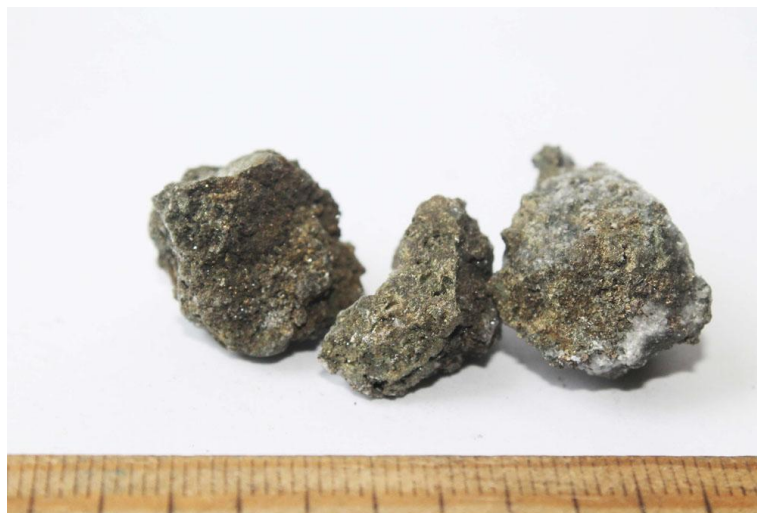
Рисунок 7: внешний вид массивных сульфидов внутренней зоны (обр. Ц-10-3,00)
