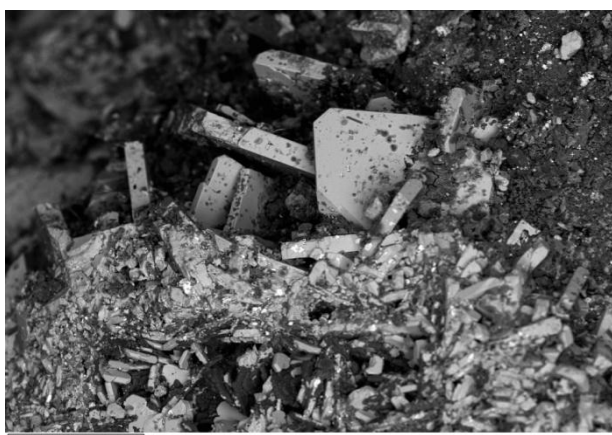
Рис.14: пластинки барита в сфалерит-барит-кремнистом рудном горизонте, электронная микроскопия (обр.В-2-4,15)
