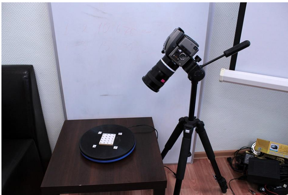
Рис.17. Калибровка блока марок с помощью поворотного столика
