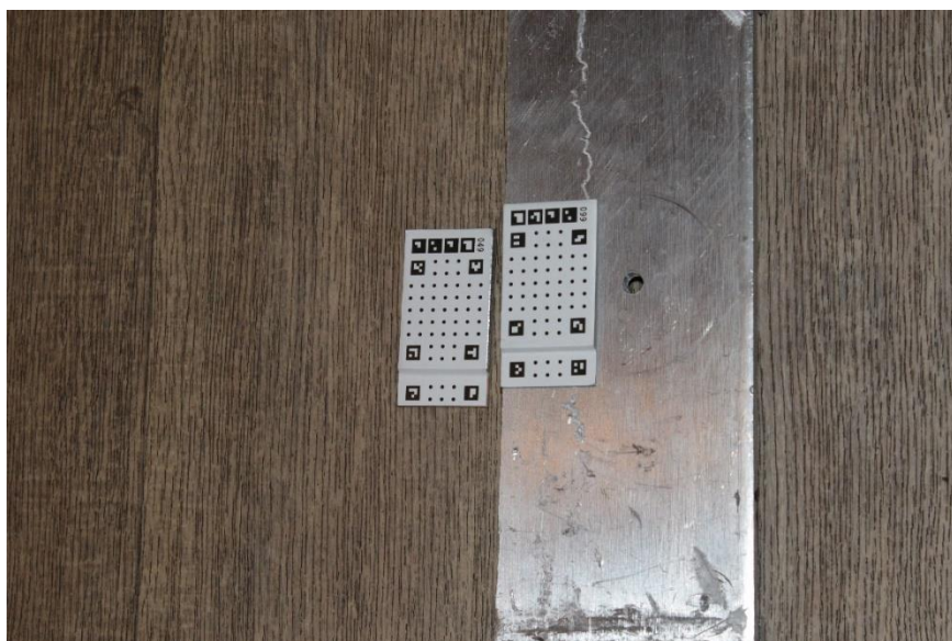
Рис.16. Пример снимка при определении предельного отступления по оси Y
