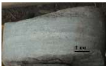
Рис. 8. Фотография керна, переслаивание аргиллитов и алевролитов, глубина отбора (3472-3527м)
