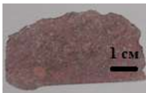
Рис. 6. Фотография образца номер Ор-1-7, доломит, глубина отбора (3527-3536 м).
