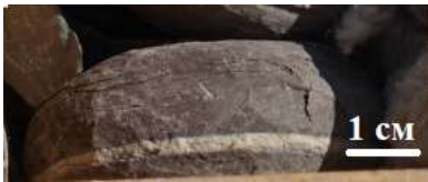
Рис. 13. Фотография керна, бурые аргиллиты с прослоем алевролитового материала белого цвета, глубина отбора (3283-3296 м).
