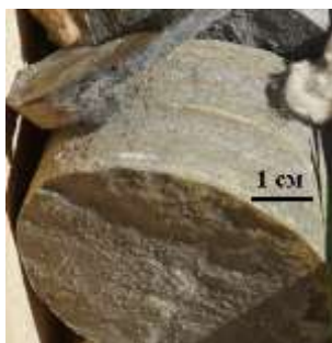
Рис. 10. Фотография керна, переслаивание аргиллитов и алевролитов, глубина отбора (3309-3324 м).
