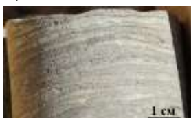
Рис. 12. Фотография керна, переслаивание аргиллитов и алевролитов, глубина отбора (3296-3309 м).
