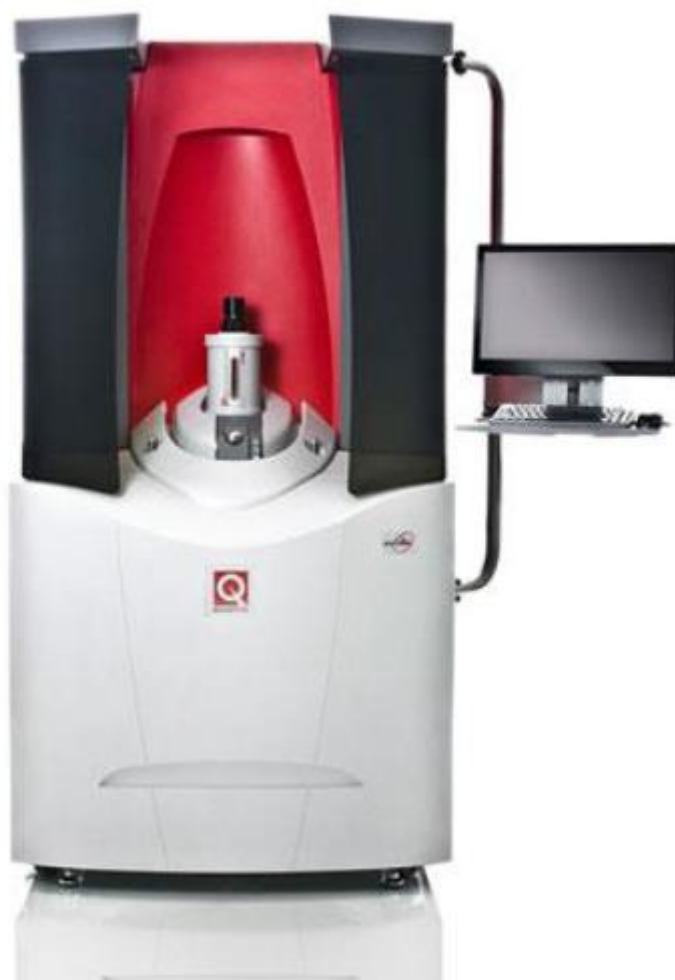
Рис.7. Внешний вид вибрационного СКВИД магнитометра MPMS3 Quantum Design.
