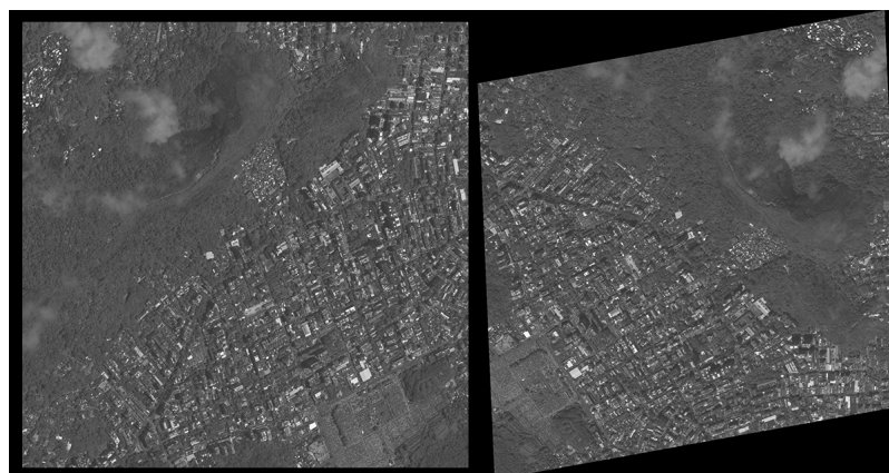
Рис. 15. а) ректификация с помощью гомографии б) ректификация с помощью аффинного эпиполярного выравнивания
