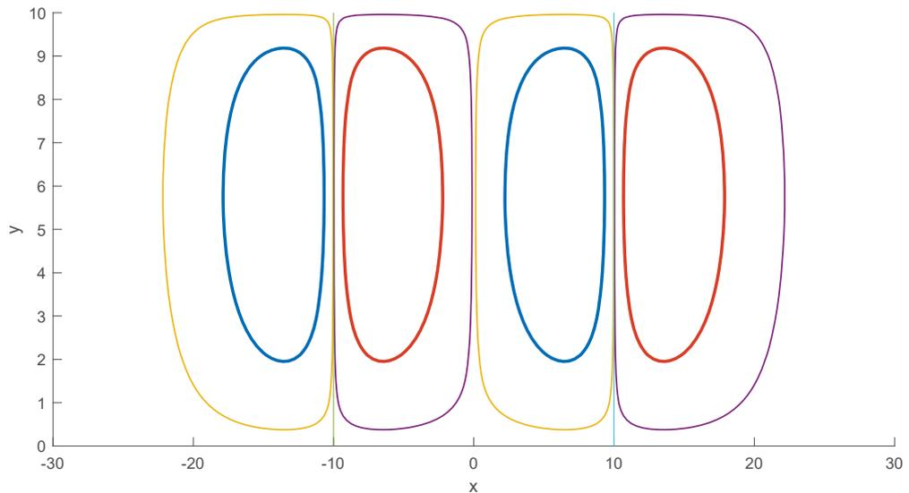
Рис. 13: Линии тока в симметричном случае распределения температур
