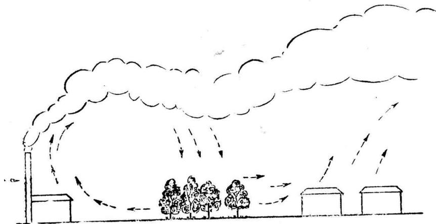
Рис. 10: Схема конвективных токов воздуха над городом
