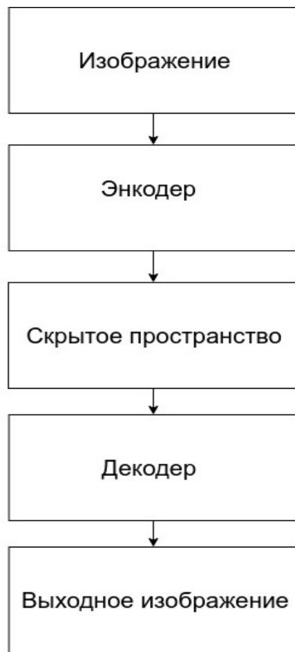
Рис. 1: Схема автоэнкодера.
