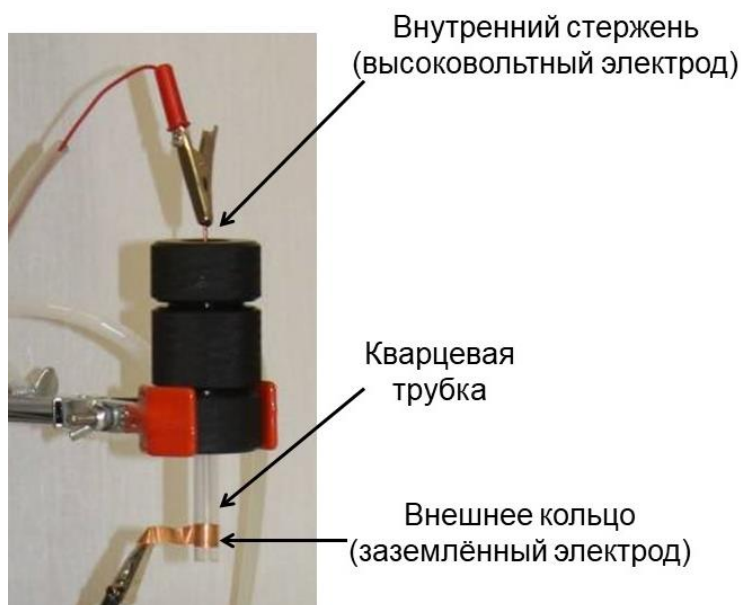
Рисунок 9 – Разрядная ячейка с системой электродов
