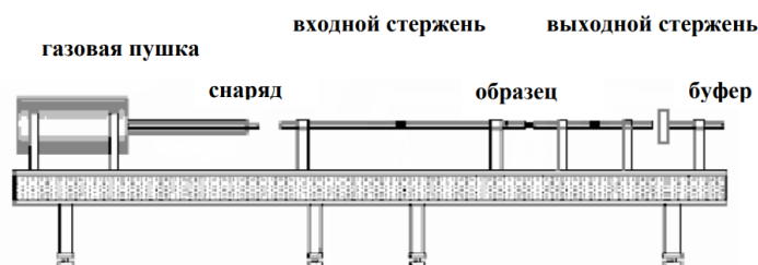
Рис. 5: Разрезной стержень Гопкинсона - Кольского [22].
