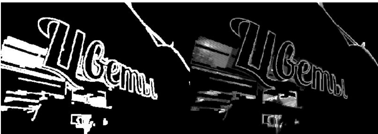
Рис. 2.7. Маска границ после морфологического расширения (слева) и результат поэлементного умножения данной маски на исходное изображение (справа).
