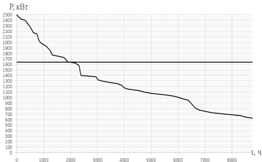
Рис. 1.7. Годовой график электрической нагрузки в параллельном режиме работы с выдачей
