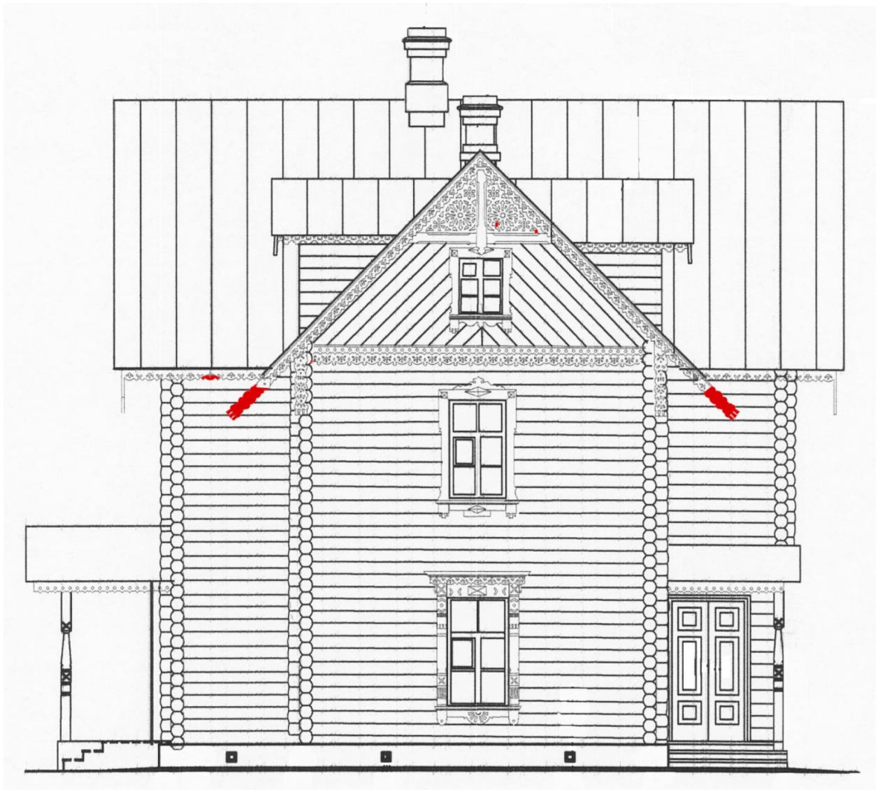
Рисунок 12. Картограмма утрат декоративных элементов, восточный фасад
