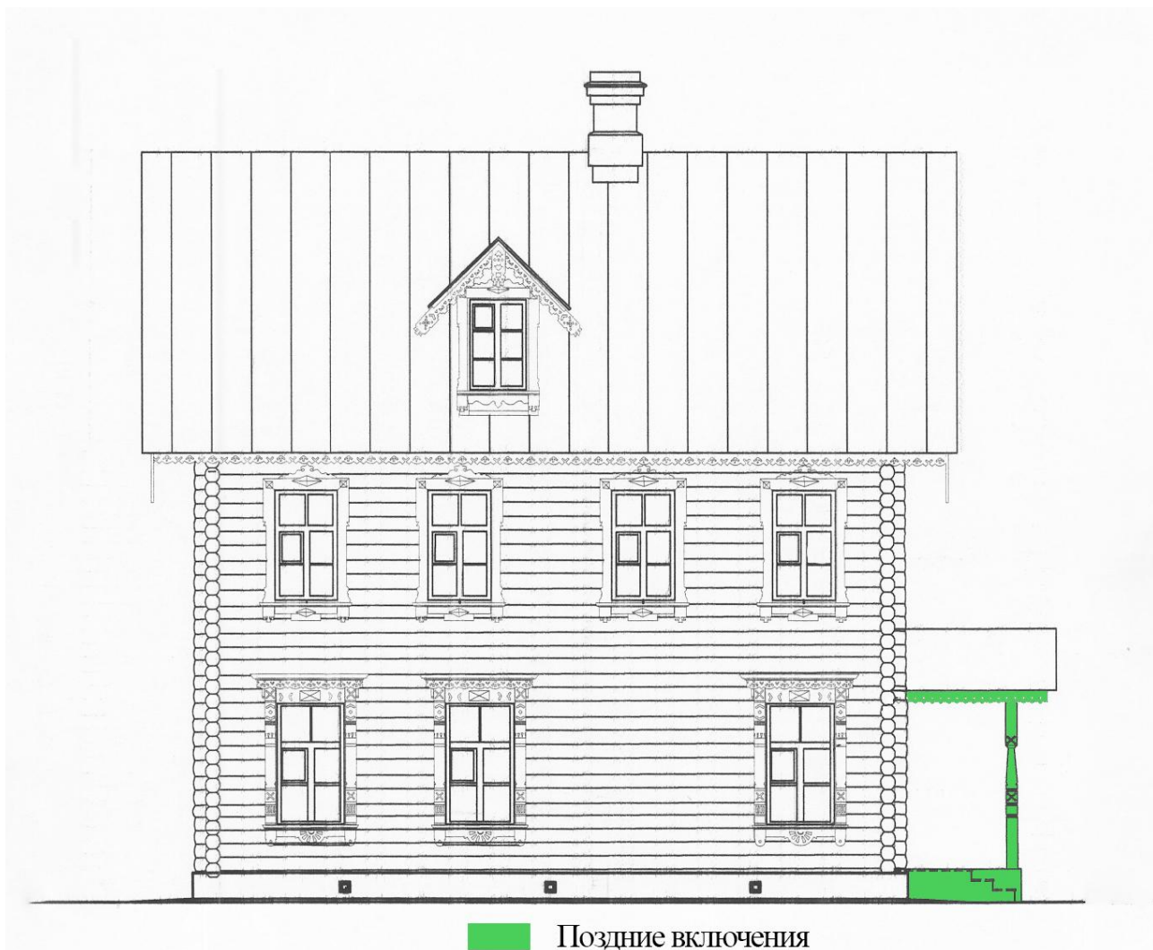
Рисунок 5. Картограмма поздних включений деревянных элементов в тело здания, западный фасад
