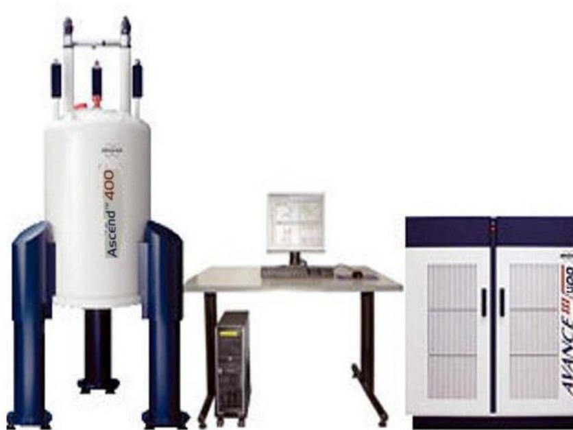
Рисунок 4. Общий вид спектрометра: магнит, консоль оператора, консоль с аппаратным обеспечением [13].
