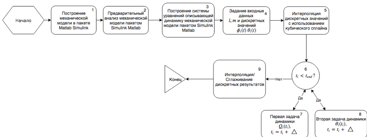
Рис. 2.5: Логическая схема работы с Matlab Simulink
