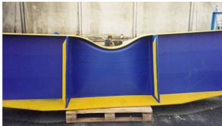
Рис. 13. Результат воздействия стального шара на бортовой стрингер [29]
