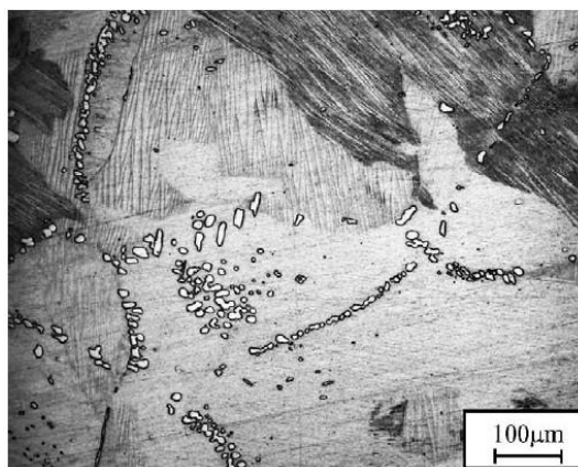
Рис.10. Структура отожженного сплава Ni-Fe-Ga в мартенситном состоянии с частицами \gamma -фазы [14].
