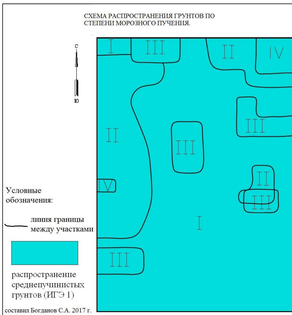
Рис.20. Схема распространения грунтов по степени пучинистости.
