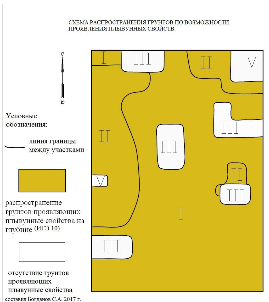
Рис.19 Схема распространения грунтов по возможности проявления плывунных свойств на Участке 3
