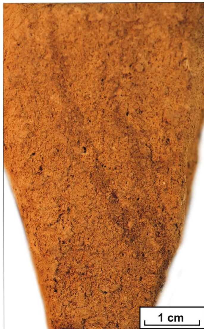
рис. 12. [Gmc]. Трещины, заполненные темным материалом из [AUg,ca].
