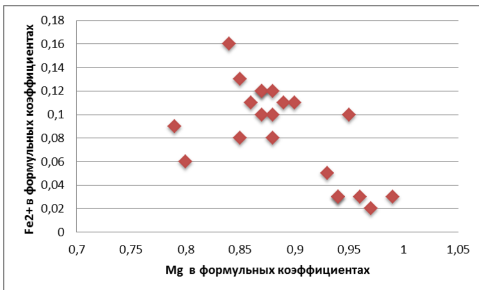
Рис 27. Зависимость двухвалентного железа и магния в пироксене.
