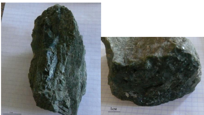
Рис. 21 Крупнокристаллический агрегат пироксена (образец №9). Рис. 22 пироксен темно-зеленого цвета, с кальцитом (образец №5).
