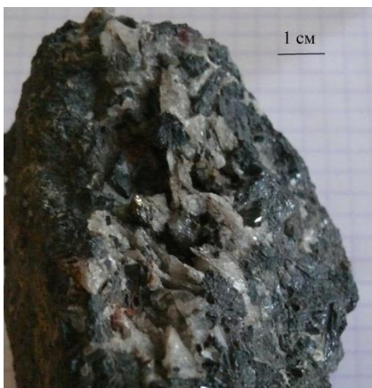
Рис. 34 Зерно пирита с кварцем, диопсидом и арсенопиритом, образец №20
