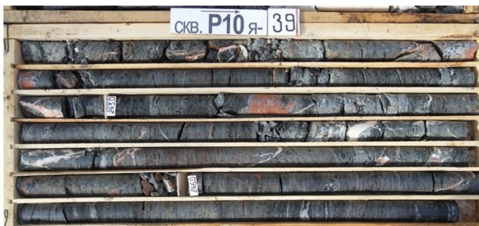
Рисунок 38. Фотография керн, на которой видны две зоны (в интервалах 240.8–243.8 м и 244.2–245.1 м) сдвиговой деформации пород.
