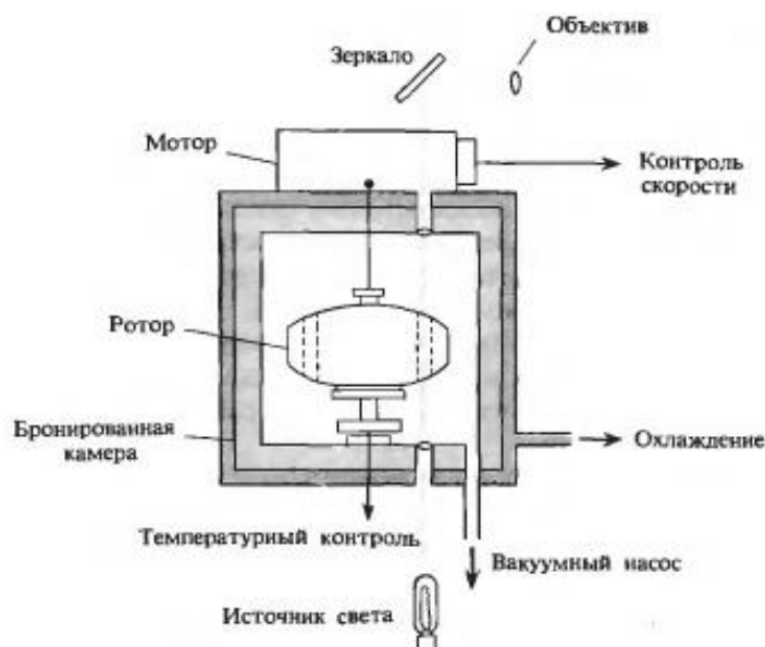
Рис,8 Схематическая установка для аналитического ультрацентрифугирования
