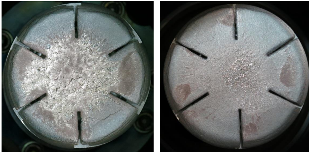
Рисунок 3.19. Слева - фотография катода TEL-50 после 2-х импульсов амплитудой \sim I_L = 42 кА. Справа - фотография катода TEL-64 после 3-х импульсов амплитудой \sim I_L = 57 кА.
