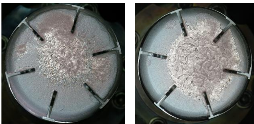
Рисунок 3.16. Фотография катода TEL-50 после протекание тока амплитудой 38.6 кА(слева) и 40.8 кА (справа).
