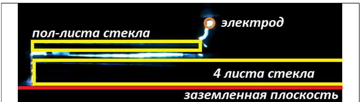
Рис. 36: Фотография пробоя: камера снимает перпендикулярно зазору. Высота зазора Z=5 мм. U=128 кВ.
