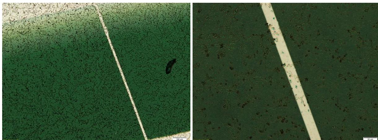
Рис. 3.5.3 Зазор между контактами на поверхности высушенной капли Ag-Phen + NaBH<sub>4</sub>.
