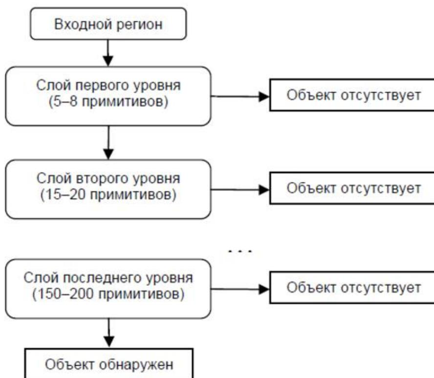
Рис.16.Пример каскадной модели «сильных» классификаторов.
